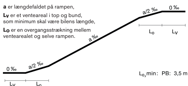
Længdeprofil for en rampe på et parkeringsareal.
