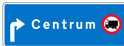
Figur 1.3. Tavle C 23,1 Lastbil forbudt anført på G 11 portalorienteringstavle.
