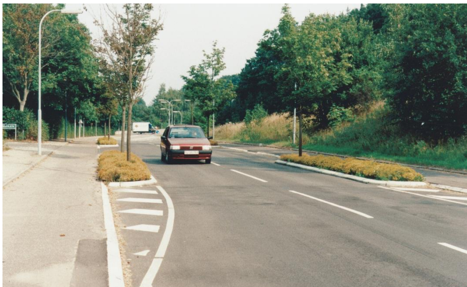
Figur 3.9 2-sporet indsnævring fra vejkant
