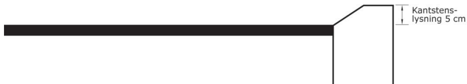
Figur 4.26 Affaset kantsten med angivelse af kantstenslysning
