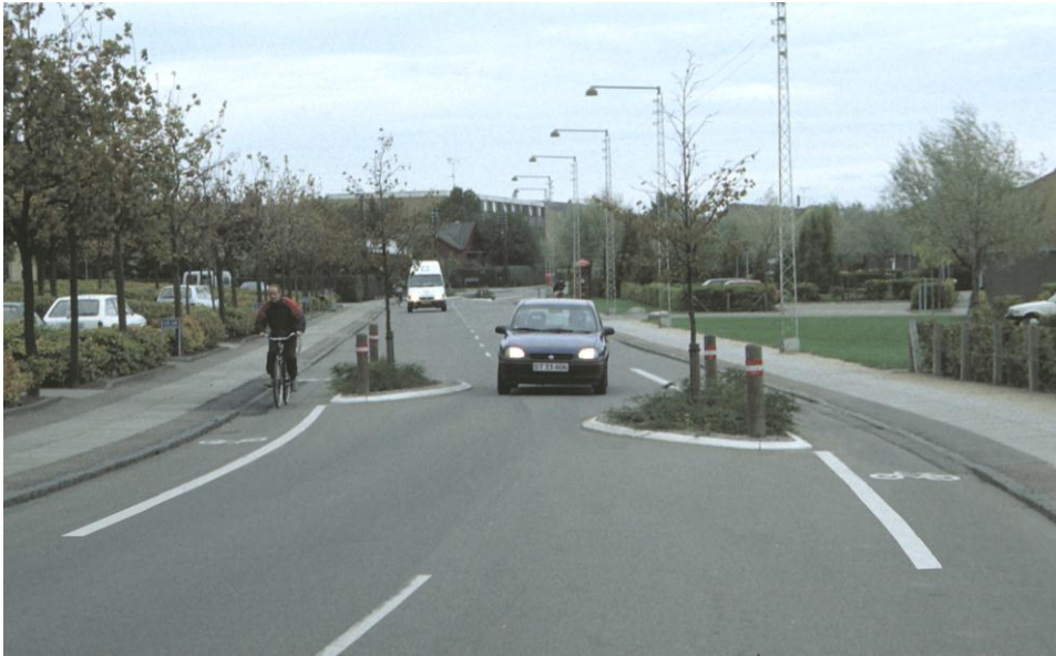
Figur 3.13 Forsætning med indsnævring
