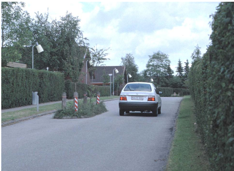
Figur 3.10 Indsnævring til 1 spor
