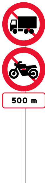
Figur 5.4. Tavlernes placering på en stander med en fælles undertavle.
