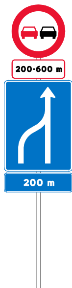
Figur 5.3. Tavlers placering på en stander med tilhørende undertavler.
